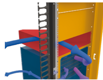
S-T-S SE DVĚMA KANÁLY PRO PODPORU PROUDĚNÍ VZDUCHU
